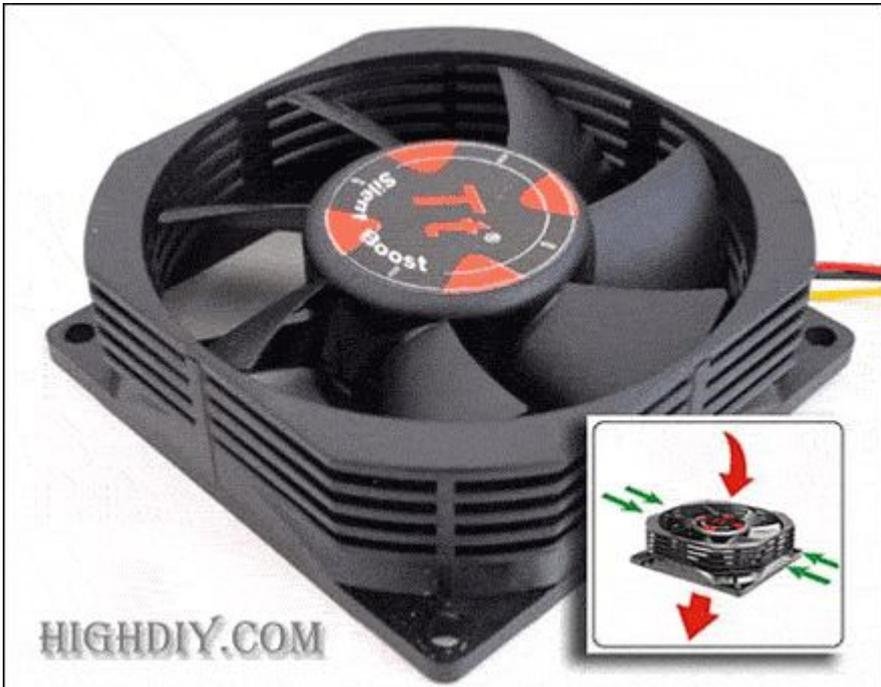
它采用了 Hyper flow(流体力学设计)，将原来的封闭式侧壁改成了百叶窗型的侧开口开放式设计，因此进风方式也随之改变，从单独的上进风变为上进风与侧进风并行。根据空气动力学的原理，上进风的方式是空气在旋转的风扇扇叶的驱使下，使其自上而下成垂直流动，此
