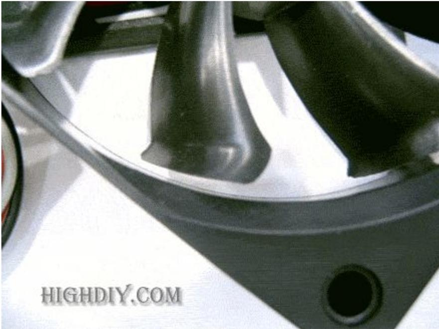
Tt 公司也推出了五面进风静音风扇，传统的风扇进风的地方主要在顶部，而它则风扇四周的提供了入口，这样它提高进风量同时不增加风扇的转速达到静音的效果。
