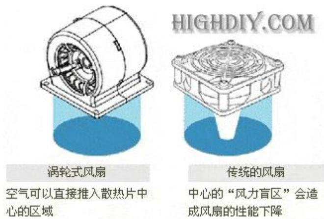
离心风机的鼓风方向上没有障碍物，所以在各个位置都有同样的气流。同时它的风压和风量的调节范围也更大，转速控制的效果更好。负面的影响和大功率轴流风机一样——价格高、噪音大。
