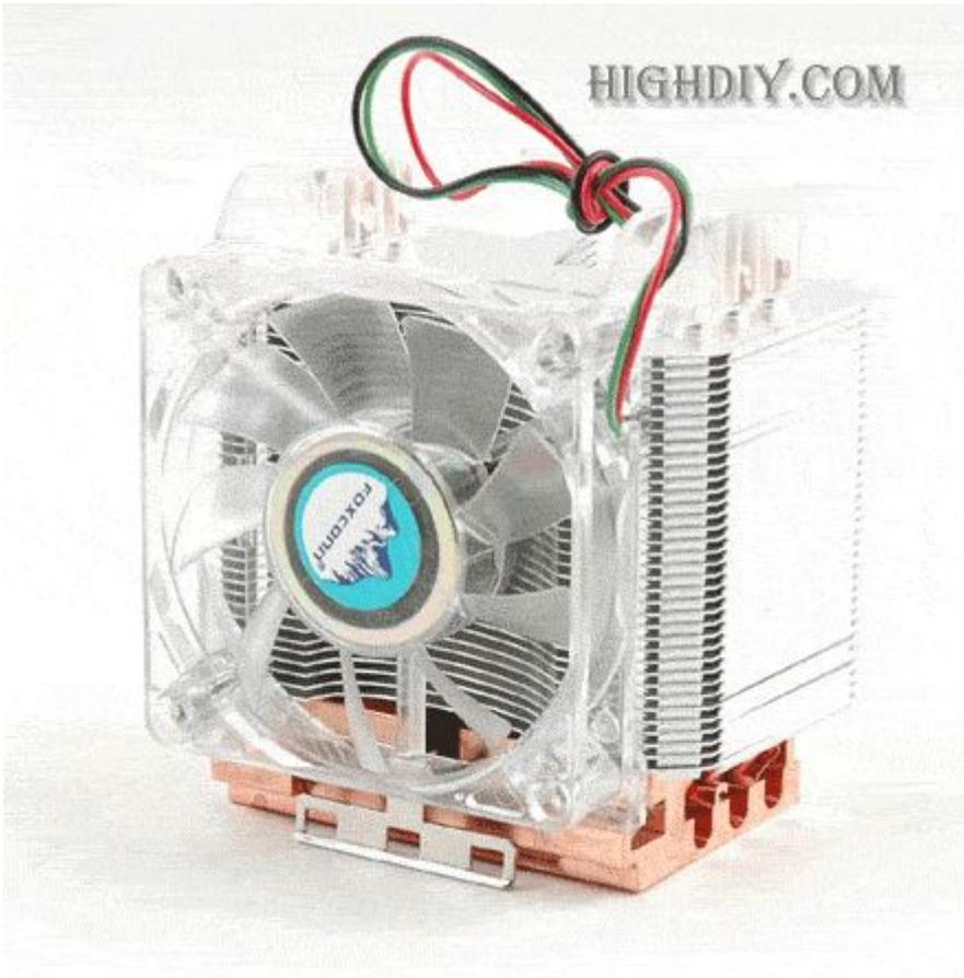
侧向吹风的首要好处是彻底解决风力盲区，因为气流是平行通过散热鳍片的，气流截面的四条边上的气流速度最快，而 CPU 的发热点正好位于一条边上。这样 CPU 散热底座吸收的热量可以被及时带走。另外一个好处是没有反弹的风压(通常向下吹风时，一部分气流冲至散热底面并反弹，这会影响散热器内的气流运动方向，使的热交换的效率受到损失)。热交换效率要高于向下吹风
