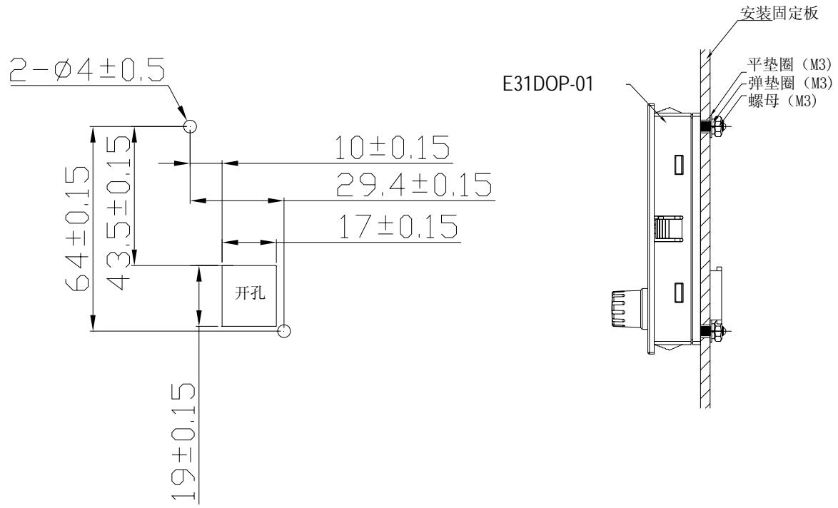
3) 面板无垫圈与螺母安装尺寸图
