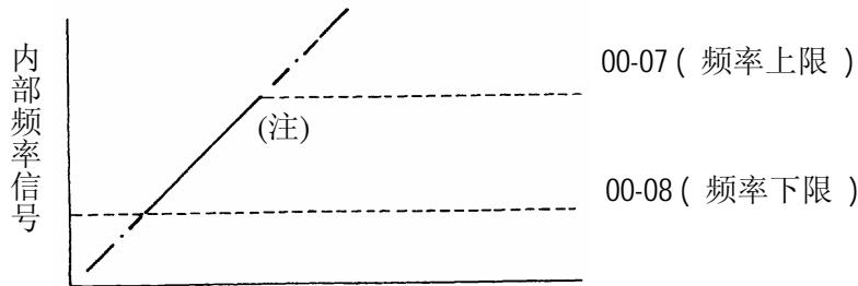
※注：若 00-08 = 0 Hz，且频率指令等于 0 Hz，则变频器零速停止。
