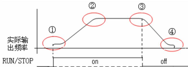
在不考虑失速的情况下，实际加/减速时间=设定加/减速时间+S 曲线时间。
