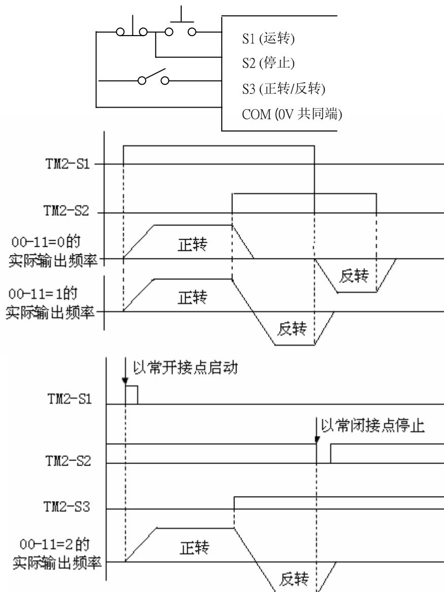
※注：1. 设定 3 线制控制模式后，端子 S1、S2、S3 不受参数 01-00、1-01、1-02 控制
