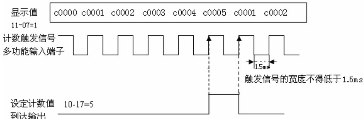
**在矢量模式时，禁止使用S6端子的“计数器触发信号输入”（1-06=20）。**
