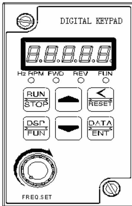
1. FUN、Hz/RPM 两种状态指示灯的动作情况，及五个 7 段数码管显示内容请参考按键面板按键操作说明
