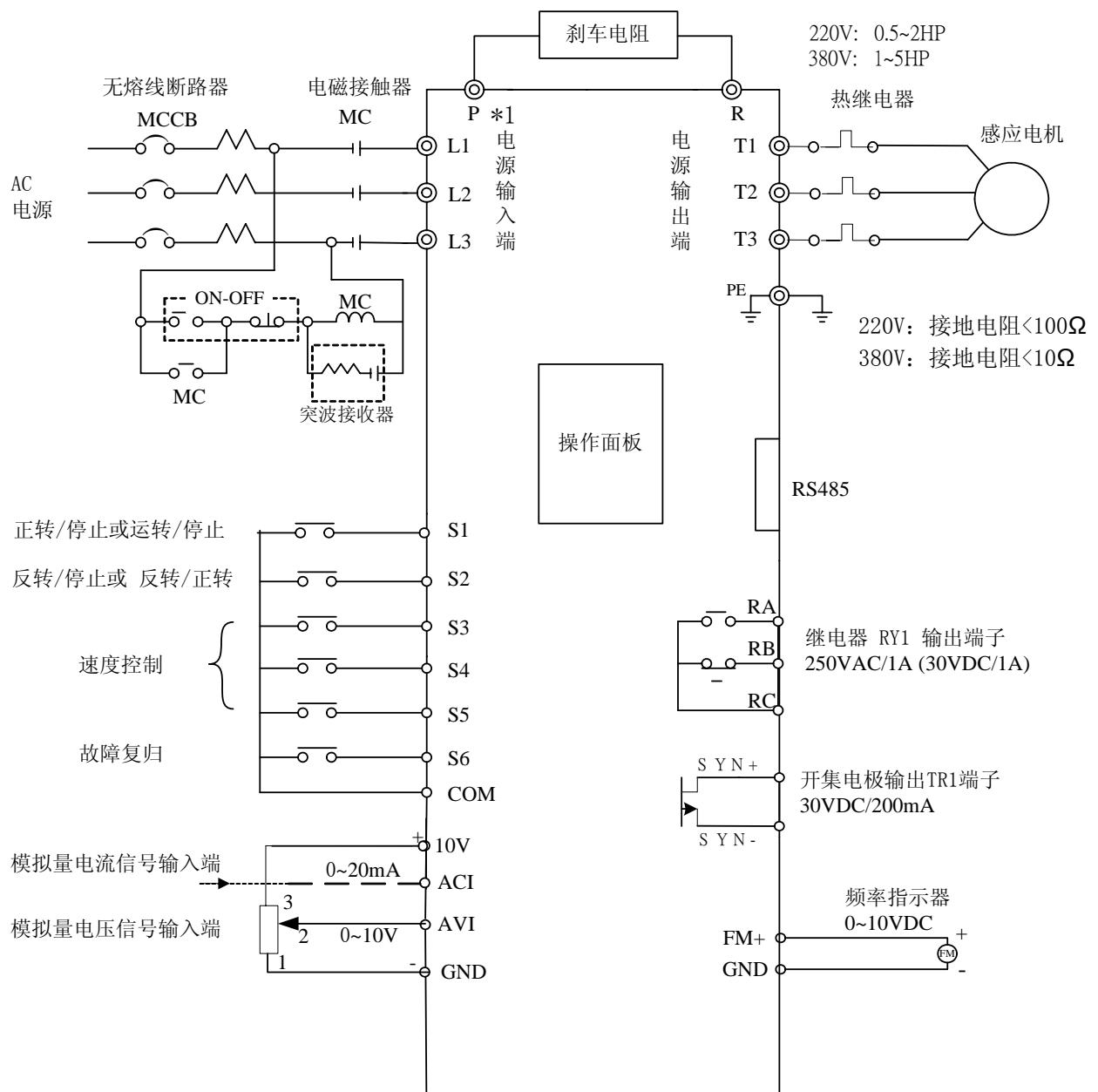
※ 注 \*1：使用时机请参考主回路端子( P、R )的说明，阻值选用参照制动电阻规格。
