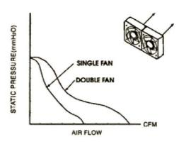
两个风扇并联所产生的风量体积,仅在自由空间条件下,为单一风扇风量的两倍,而当并联风扇应用于较高系统阻抗的情况时,系统阻抗愈高,并联风扇所能增加的风量愈低。因此,并联的应用仅在低系统阻抗的情况下建议使用,即风扇在几乎完全自由送风的情况下运作。 串联风扇与单独风扇的运作曲线图
