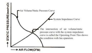
在工作点,风扇特性曲线之变化斜率为最小,而系统特性曲线之变化率为最低。注意此时的风扇静态效率(风量 ×风压 ÷耗电)为最佳化。 设计时应考虑项目:
