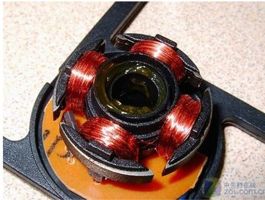
含油轴承（Sleeve Bearing）是使用滑动摩擦的套筒轴承，使用润滑油作为润滑剂和减阻剂。可以说是现在市场上最常见的一种轴承技术，由于成本低廉，制造简单，不少产品包括知名品牌都还在继续使用中。
