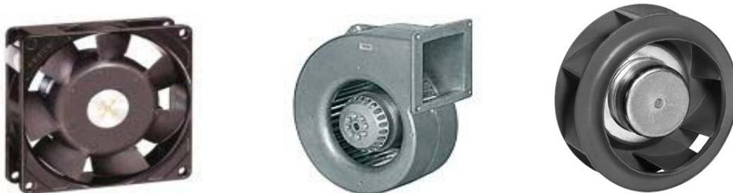
直流无刷风扇工作原理：风扇转子上存在磁性橡胶磁铁，电路板上霍尔元件会感应其磁场，以此决定电路对矽钢片上绕线线圈的通断电，两个磁场间产生的吸斥力推动风扇转动，霍尔同步感应橡胶磁铁磁极后再切换通电线圈，从而使风扇可以持续运转。
